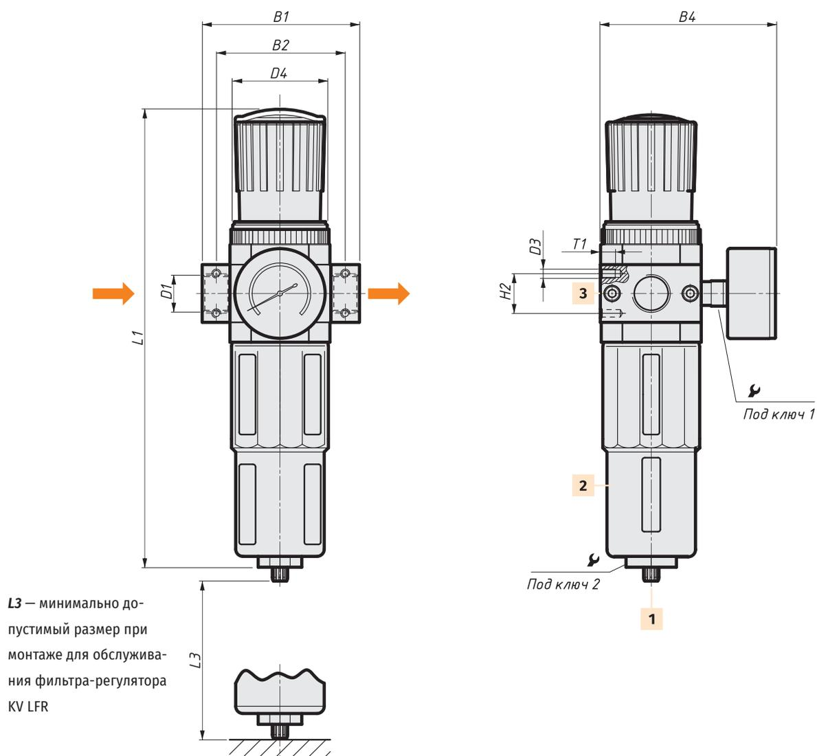
$L3$  — минимально допустимый размер при монтаже для обслуживания фильтра-регулятора KV LFR
