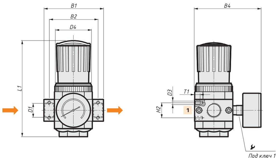
**1** Второй порт для подключения манометра
