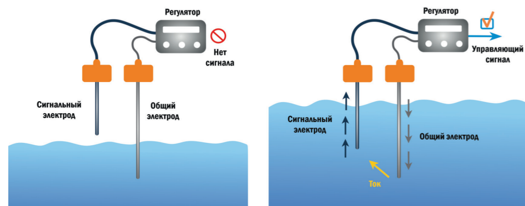
Рис. 1. Принцип работы кондуктометрических датчиков уровня
